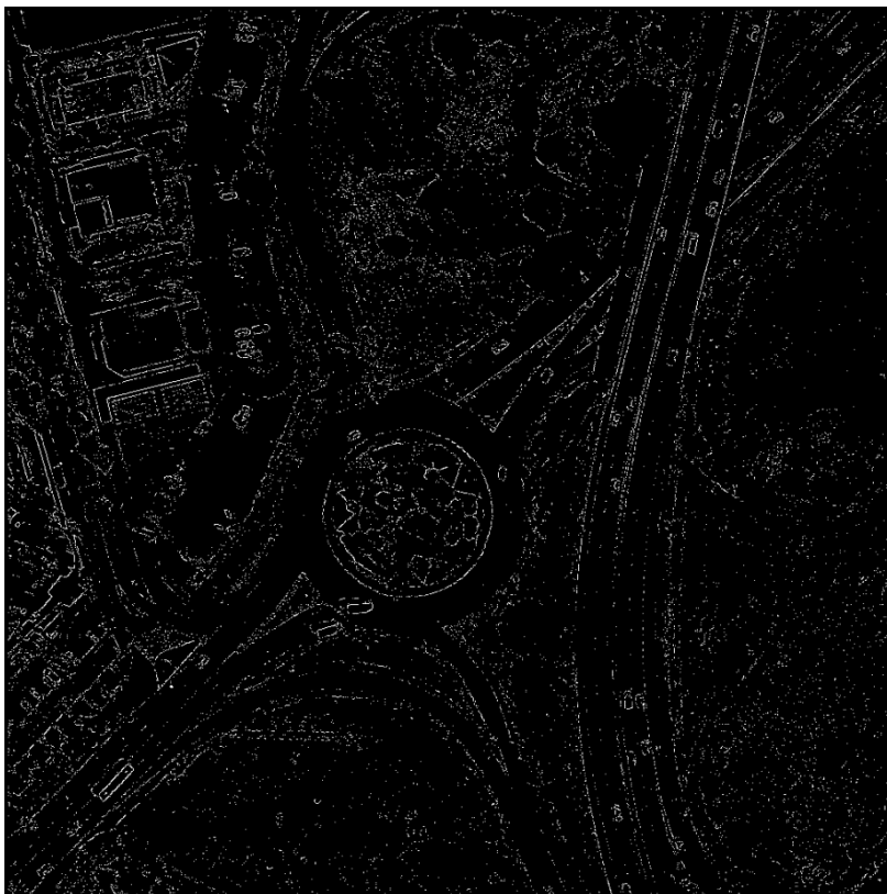
Фиг. 3. Метод за откриване на ръбове SUSAN, приложен върху входното изображение
